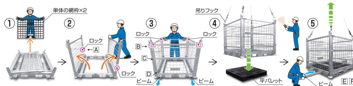
付属単体の網枠を外しながら、本体両サイドの網枠を立上げロック(※)してください。
