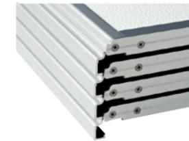
防音アフィラウォールは、仮囲いパネルでは初めて段付き形状にて設計しました。製品が外枠のフレームで重なり合い、製品同士がズレず、平積みによる保管・運搬が可能になりました。表面の面材同士も接触しない形状ですので、製品同士の接触によるコスリキズ等を防止する働きも持ち合わせ、補修の軽減に繋がります。また専用のパレットが不要で、木製のパレットにて保管運搬も出来ますので、取扱いが格段に簡易になり、現場並びヤードでの保管効率の向上、運搬時の効率UPのお役に立てます。
