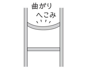
④各部の接合に割れやいちじるしい腐食がありませんか。また、取り付け部品の破損・脱落・変形・摩耗・いちじるしい腐食がありませんか。ある場合は、絶対に使わないでください。
