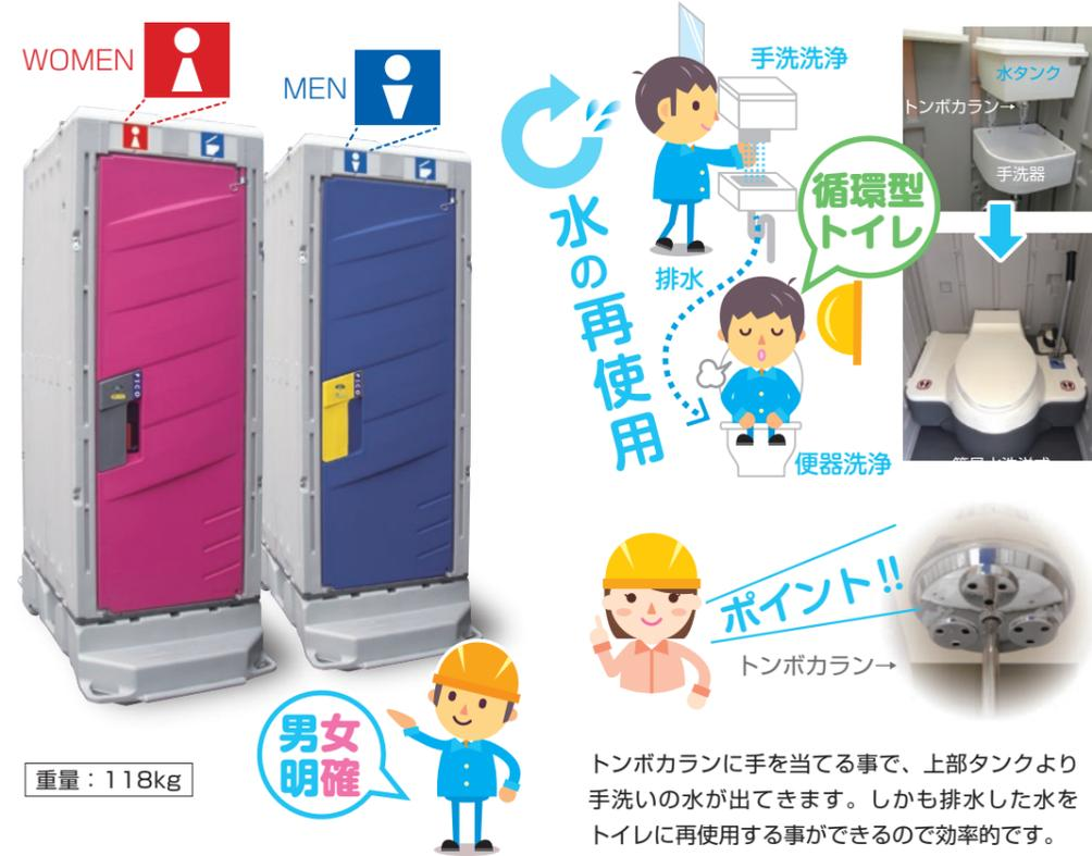
トンボカランに手を当てる事で、上部タンクより手洗いの水が出てきます。しかも排水した水をトイレに再利用する事ができるので効率的です。
