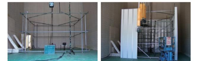
・受音点では仮囲いを透過した音と仮囲いの上から回り込んだ回折音を受音します。
