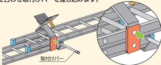
③ 差し込み後、取付けバーの先端を折り、抜け止めをする。
