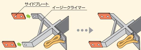
② 使用する長さに合わせて梯子を重ね、梯子とサイドプレートの穴を合わせ取付けバーを差し込みます。
