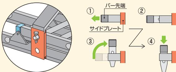
④ 同じ手順でもう一つの穴に取付けバーを差し込み、抜け止めをする。
