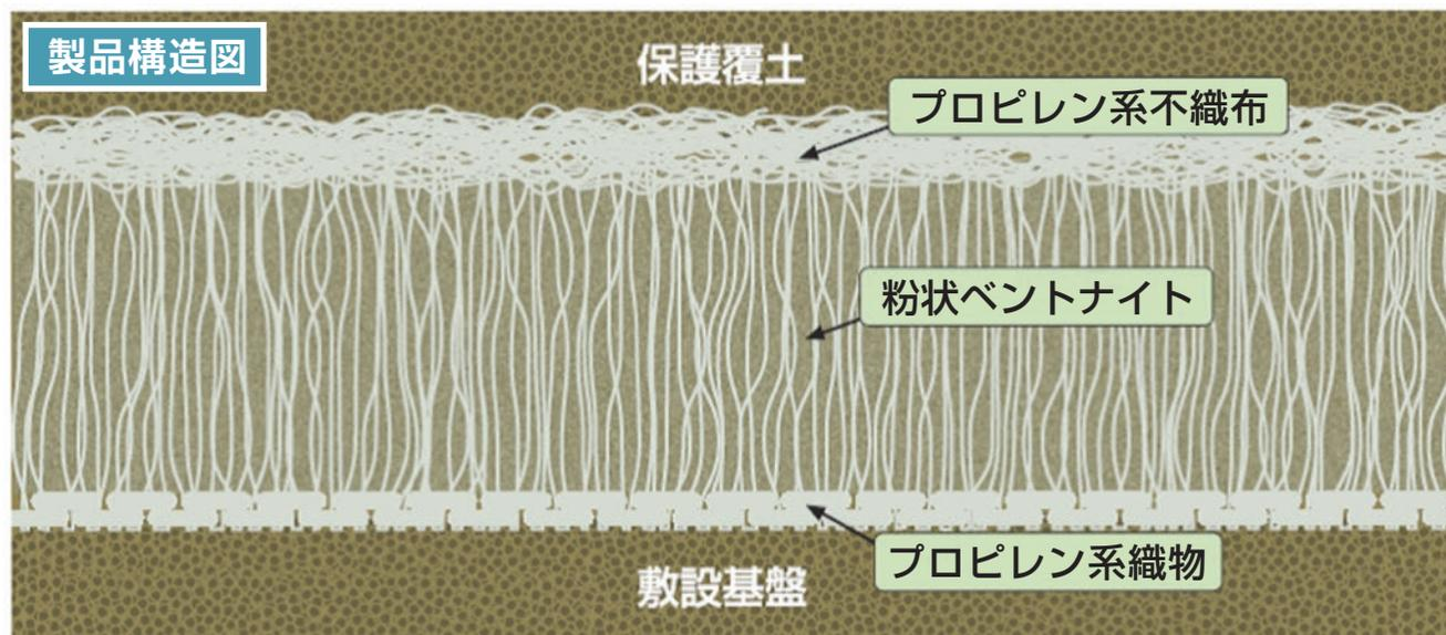
織布側に貫通したニードルパンチされた糸 (200 ~ 300 万本 / m<sup>2</sup>) は織布側で熱溶着されています。
