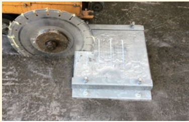
内部のアラミド繊維により回転防止機能が作動し、回転が停止。
