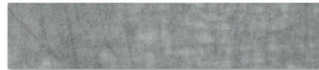
テクトン™はヒートボンドタイプのスパンボンド不織布で、360度どの方向から引張っても同様の強度を得られます。その特色は軽量ながら高強度、水中での強度低下がなく、極薄の為、目詰まりを起こしにくく、長期に亘り透水性を維持します。
