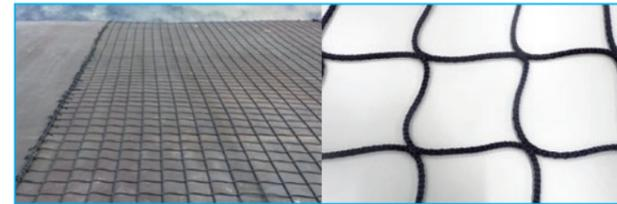
柔軟性に優れ、被災者が地上まで這い上がるのをアシストします。紫外線に強い糸を使用することにより、耐候性に優れます。材質-再生ポリエステル、目合い-100mm、強度-平均2kN以上/本 耐候性-7500h照射後強度保持率90%以上 (サンシャインウェザーメーター促進暴露試験) ※約30年に相当。
