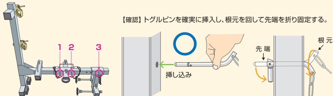
【注意】トグルピンは、根元を上向きにして挿入してください。根元が下向きだと、先端が折れ曲がり、うまく貫通できません。
