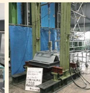
【②ハゼ取付金具引張試験】 【③ハゼ取付金具圧縮(滑り)試験】
