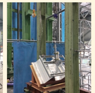
【②ハゼ取付金具引張試験】 【③ハゼ取付金具圧縮(滑り)試験】
