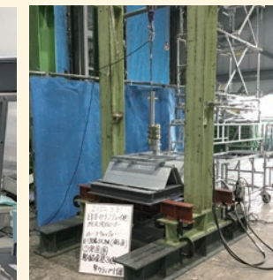
【②ハゼ取付金具引張試験】 最大荷重: 14.12 kN
