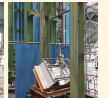
【②ハゼ取付金具引張試験】 最大荷重: 14.12 kN
