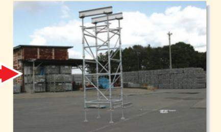
注) 必ず、水平・垂直になる様、取付け設置する。
