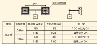
4) 墜落防護工安全基準(第2種)に基づく支柱の静荷重試験
