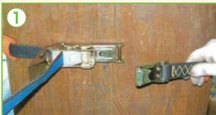
1 各コーナーに当ベルトを装着し、主ベルトの端部フックをマグネットベースに接続します。
