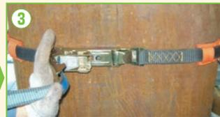
3 安全カバーを手で押さえストッパー金具に連結します。
