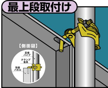
最上段はクランプのフックを下向きに取付ける。
