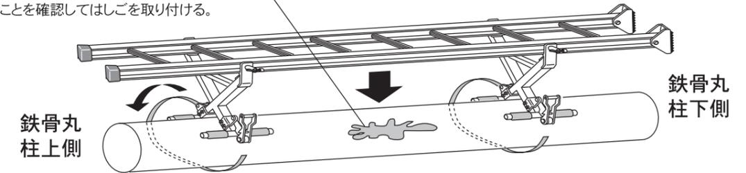
**2** ベルトをファスナーの巻取りドラムに通し、矢印の方向へベルトを引っ張りベルトのたるみを取ってください。
