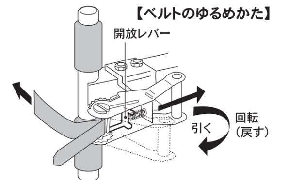
**4** ベルトを矢印の方向に引っ張って、巻取りドラムから完全に抜き取り、鉄骨丸柱から取り外してください。
