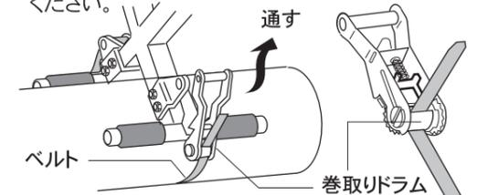
**3** ベルトを鉄骨柱に密着させ、たるまないように手で締めてから、作動レバーを前後に繰り返して動かす、確実に締め付けてください。
