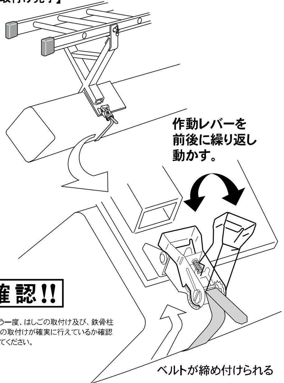
④ もう一度、はしごの取付け及び、鉄骨柱への取付けが確実にできているか確認してください。
