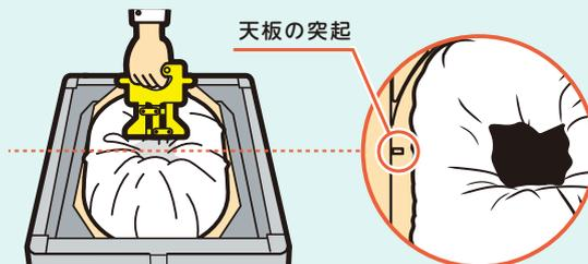
必ずフィルムが左右のローラーに挟まれていることを確認してください。フィルムがはずれている時は、もう一度、ジグリンを差し込んでください。
