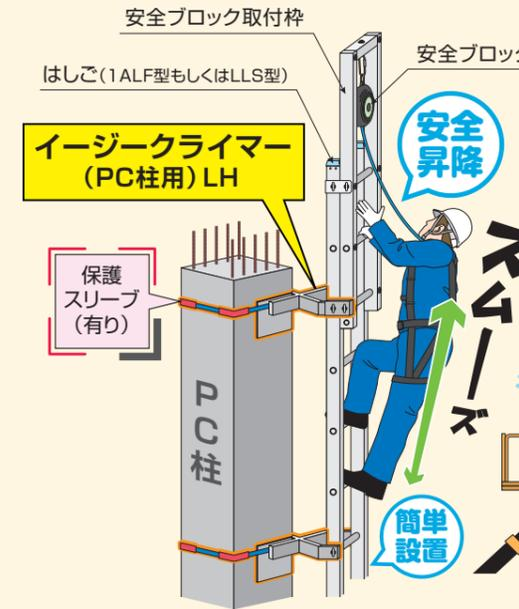
はしご取付金具イージークライマーは、建築現場の梁などの組立作業時に仮設の昇降用通路となるはしご (1ALF型もしくはLLS型) をPC柱に取付ける装置です。PC柱への脱着はベルトで行います。オプションで安全ブロック取付枠・安全ブロックをセットで取付けると安全に昇降が行えます。
