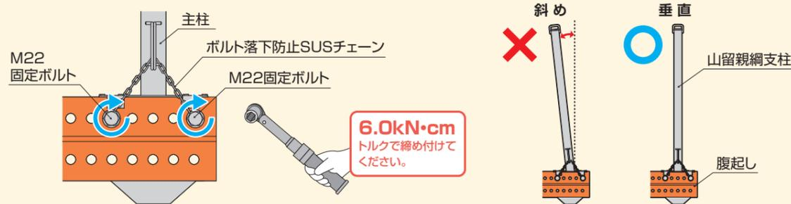
⑤ 親綱保持器具に支柱用親綱を取り付け、緊張器でたるまない程度緊張し、設置完了です。
